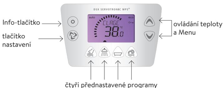
Jak efektivní je DSX v provozu, je patrné na první pohled: skutečný příkon a nastavená teplota je přehledně zobrazena na displeji. Barva podsvícení signalizuje zvolenou teplotu, kdy plynule přechází od modré (studená) přes fialovou do červené zóny (horká).
